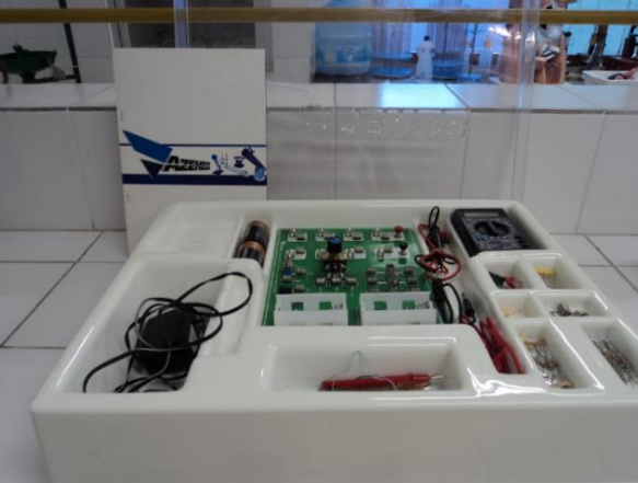
Figura 4. Fotografia do kit de laboratório didático de eletrodinâmica
