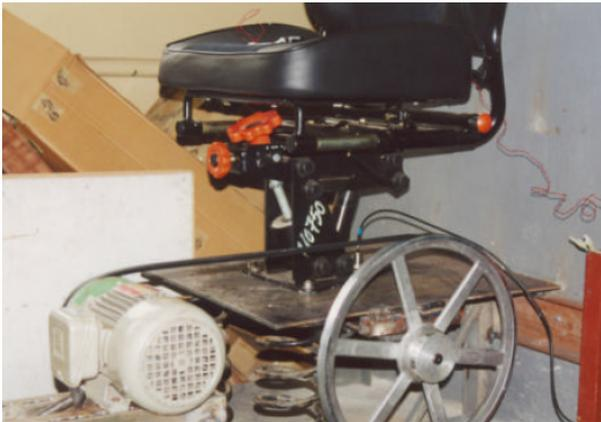
Figura 3.3.: Estrutura usada na UFRGS para ensaios de vibrações de ônibus urbanos [83].
