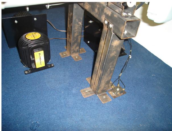
Figura 4.5.: Posicionamento do acelerômetro em relação ao apoio esquerdo da poltrona.
