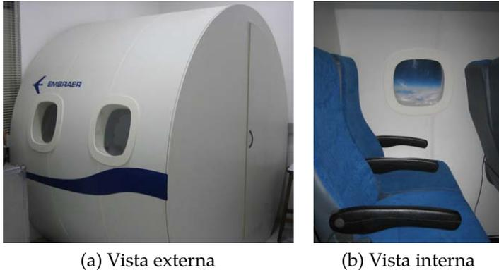
Figura 3.1.: Simulador de ruído de aeronaves localizado no LVA da UFSC para os ensaios de qualidade sonora [25, 46].
