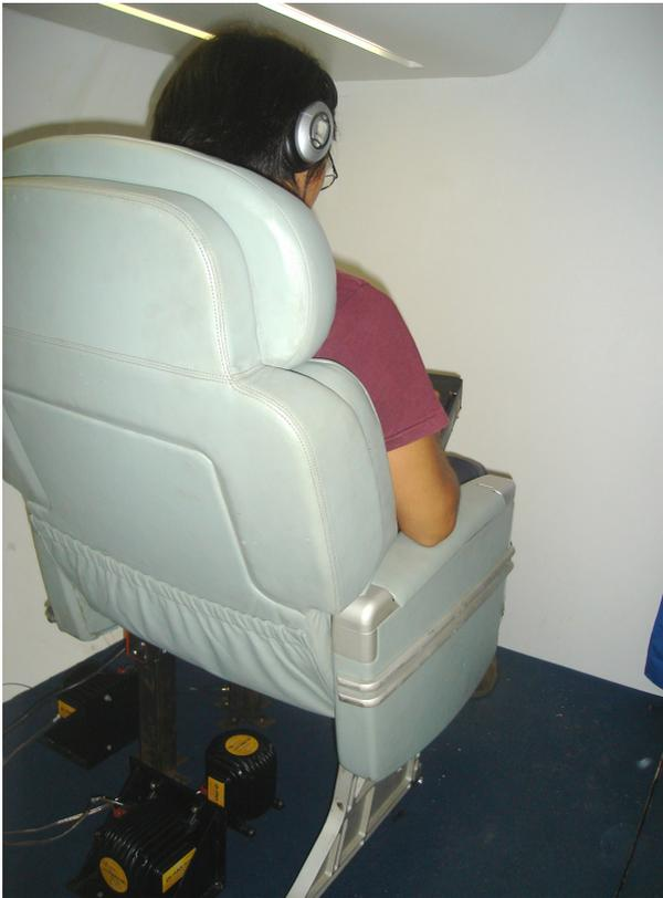
Figura 4.6.: Imagem de um jurado realizando o ensaio, com vista traseira para visualização dos fones, da poltrona e dos excitadores de vibração.
