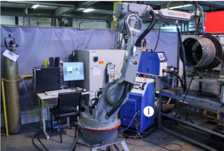
Figura 24: Segunda concepção da bancada de ensaios para soldagem de tubos com um robô antropomórfico
