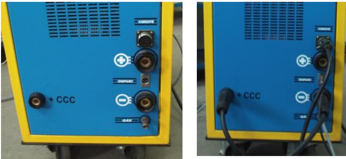
Figura 113: Fotos mostrando o novo borne para o processo CCC
