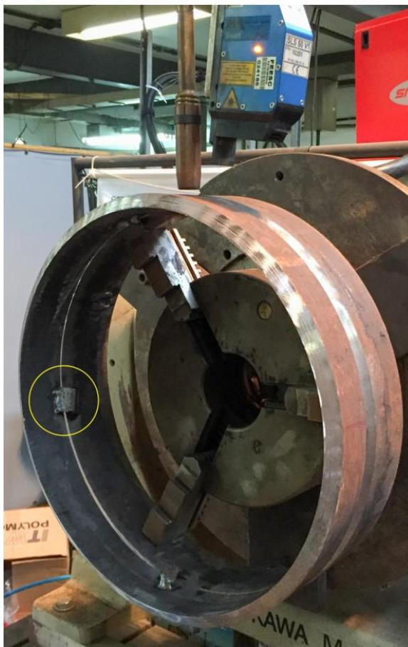
Figura 70: Montagem do corpo de prova para soldagem
