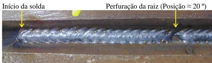
Figura 34: Perfuração da solda em um passe de raiz de duto com as variáveis de movimentação e elétricas constantes
