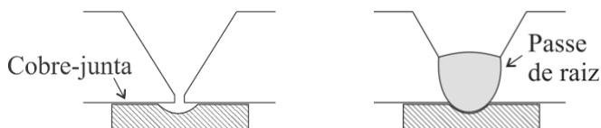
Figura 3. Representação esquemática de um cobre-junta, antes (esquerda) e depois da solda do passe de raiz (direita)
