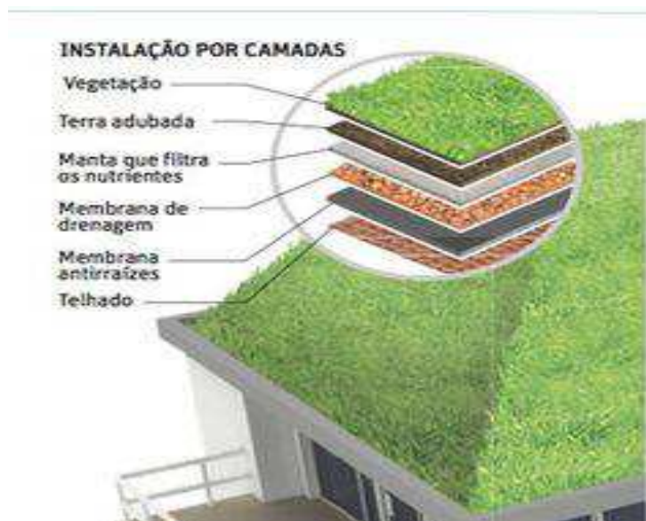
Figura 9 – Modelo de telhado verde
