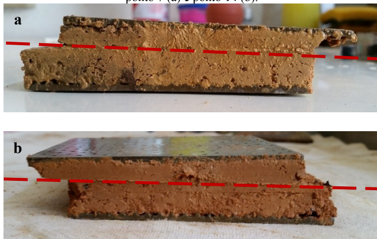
Figura 46. Amostras de solo após a execução do ensaio de cisalhamento direto: ponto 7 (a) e ponto 14 (b).
