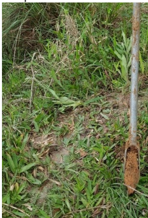
Figura 36. Execução do furo e coleta da amostra de solo.
