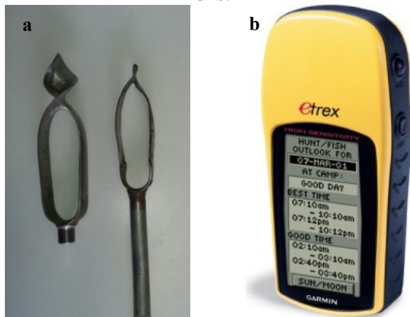
Figura 34. Equipamentos utilizados nas expedições a campo: (a) trado e (b) GPS.
