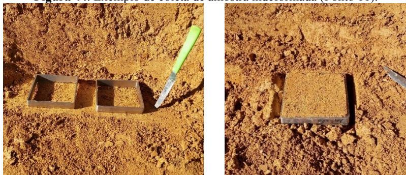
Figura 44. Exemplo de coleta de amostra indeformada (Ponto 11).
