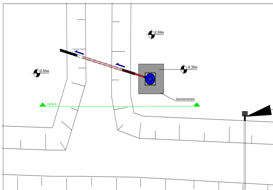
Figura 5. Vista superior da instalação da Bomba.
