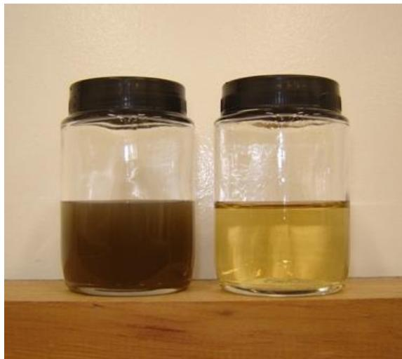
Figura 4.19. Fotografia retirada das amostras de caldo pré-filtrado (esquerda) e caldo clarificado na membrana cerâmica M1 (direita).
