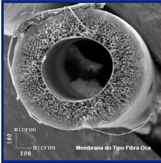
Figura 3.1. Fotografia de microscopia eletrônica de membrana do tipo fibra oca.
