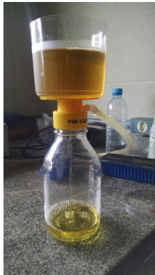
Figura 2: Esterilização dos nutrientes por filtração a vácuo.
