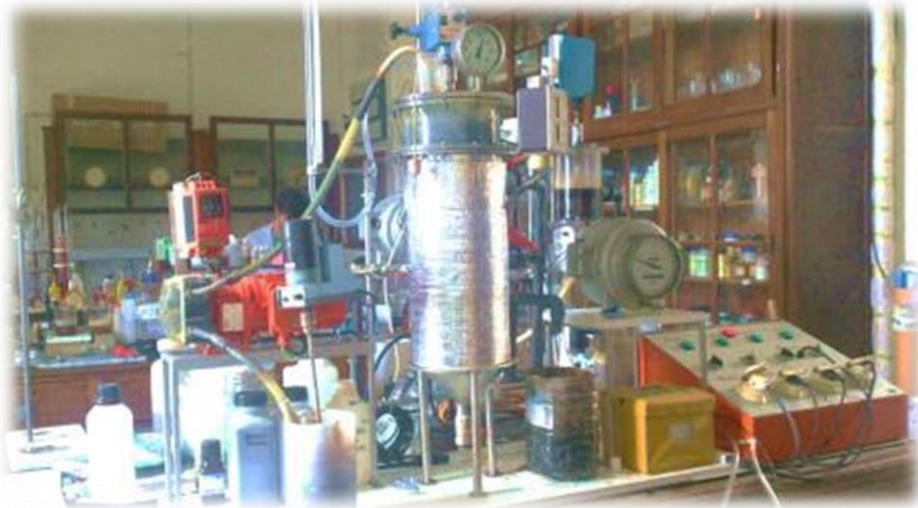
Unidade laboratorial de digestão anaeróbia (ULDA) I
