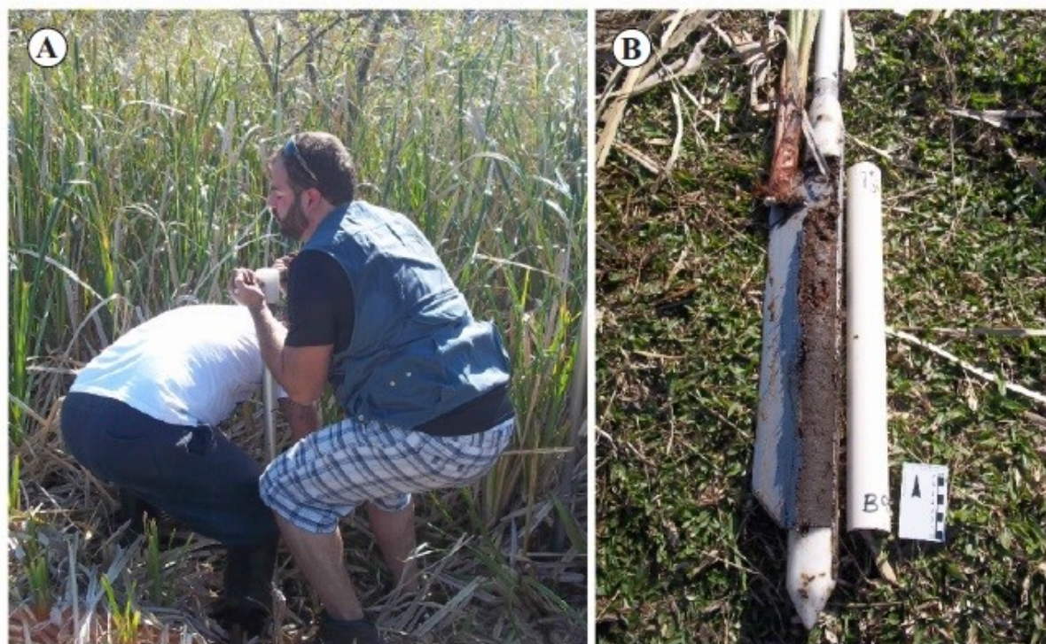
Figura 13: Método de amostragem em sedimentos paludiais. A. Retirada do amostrador com o sedimento coletado no ponto SIRT01. B. Testemunhador e parte do registro sedimentar adquirido neste ponto. (Fotos: arquivo pessoal da autora, jun/2015).
