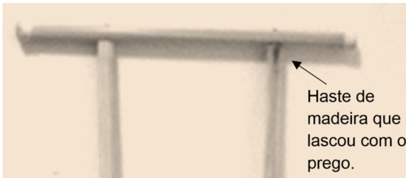
Figura 11 – Haste lascada, problema na etapa de experimentação. Fonte própria.
