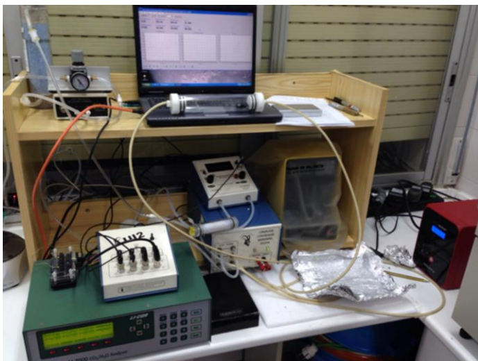
Respirômetro com analisador de CO 2 e H 2 O para medida de taxa metabólica de insetos.
