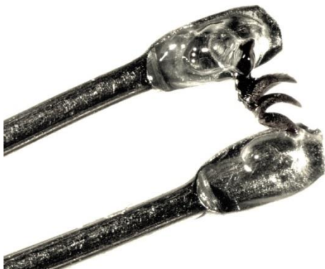
Antena de escarabeíneo montada nos eletrodos, experimento de eletroantenoграфия.
