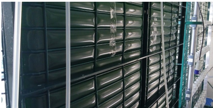
Figura 7 - Fotobiorreatores verticais fechados com culturas de Scenedesmus obliquus .
