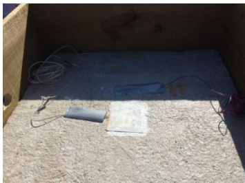
Figura 31 - Sensores instalados na superfície superior da plataforma de concreto
