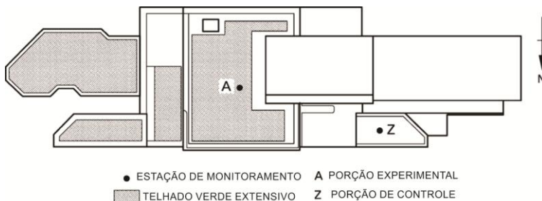
Figura 9 - Localização das estações de monitoramento na cobertura da Estação de Trem Tai Po
