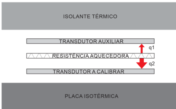
Figura 49 - Sistema de calibração com transdutor auxiliar
