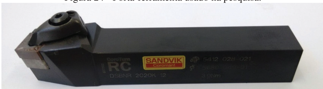
Figura 24 - Porta-ferramenta usado na pesquisa.
