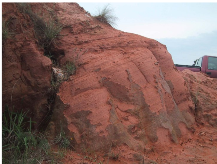
Figura 28- Estratificação cruzada e plano paralelos em um afloramento da jazida de empréstimo
