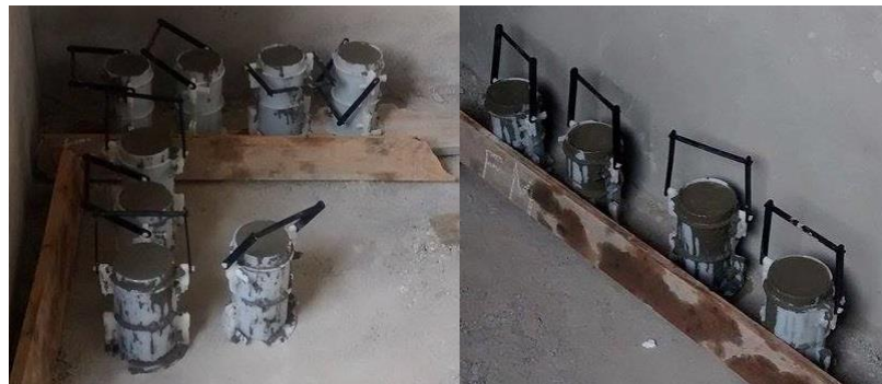
Figura 10 – Corpos de prova nas primeiras 24 horas.
