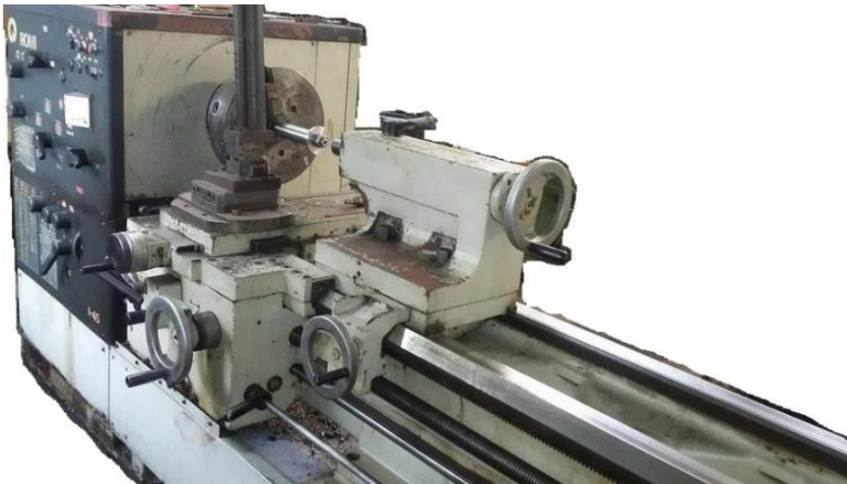
Figura 3.2 – Dispositivo QSD montado no Torno Romi I-45.
