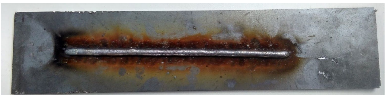
Figura 45 - Cordão n°3, arame de aço ER70S-6, com 1,2 mm de diâmetro, controle valores extremos.
