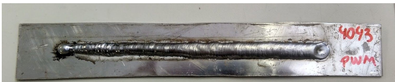
Figura 43 - Cordão nº1, arame de alumínio ER4043, com 1,2 mm de diâmetro, controle PWM.
