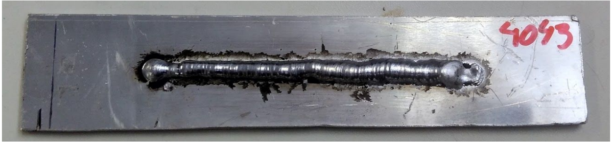
Figura 44 - Cordão n°2, arame de alumínio ER4043, com 1,2 mm de diâmetro, controle valores extremos.
