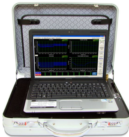
Figura 31 - Sistema de Aquisição Portátil - SAP [20].
