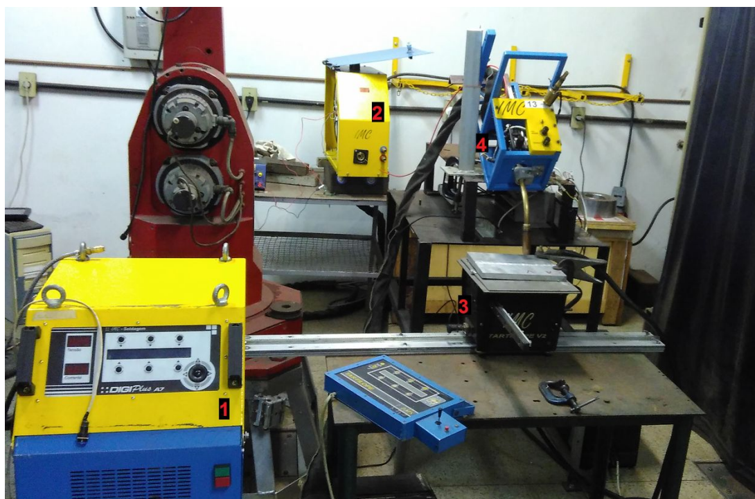
Figura 32 - Disposição geral dos equipamentos: 1 - Fonte de soldagem; 2 - Cabeçote de alimentação de arame; 3 - Tartilope V2; 4 - Protótipo de alimentação dinâmica de arame.
