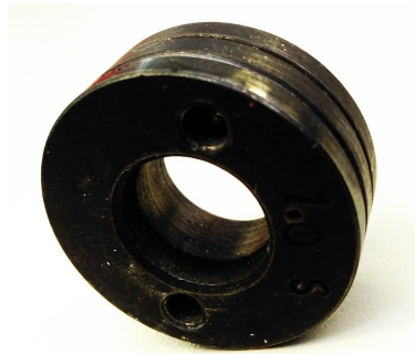
Figura 18 - Rolete utilizado para deslocamento de arame.
