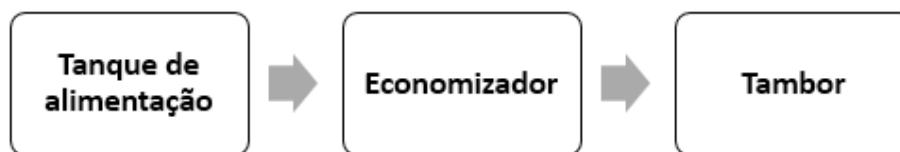
Figura 13 – Diagrama de blocos do sistema de água de alimentação. (Fonte: AUTOR, 2016)
