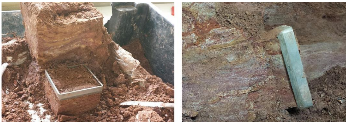
Figura 25. Procedimento para moldagem dos corpos de prova destinados ao ensaio de cisalhamento direto. À esquerda CP orientado paralelamente a xistosidade, à direita CP orientado perpendicularmente a xistosidade.
