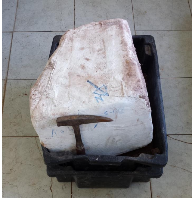
Figura 24. Bloco indeformado envolvido em papel filme e atadura gessada para condicionamento em câmara úmida.
