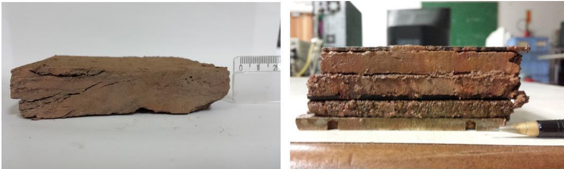
Figura 27. Exemplo de superfícies de ruptura inválida (à esquerda) e superfície bem desenvolvida, válida (à direita)
