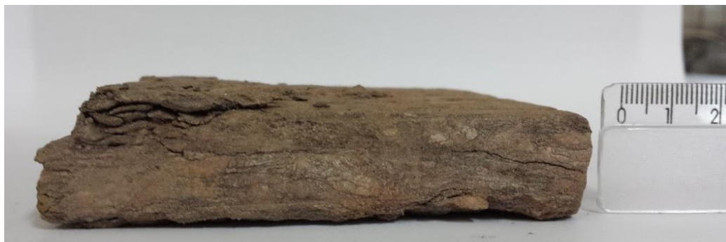
Figura 40. Corpo de prova do Bloco A, com má formação da superfície de ruptura, orientada paralelamente a xistosidade.
