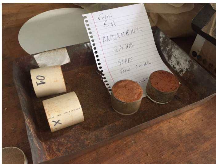
Figura 27 - Amostras expostas ao ar (24 e 48 horas) para variação da umidade.
