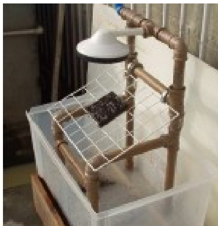
Figura 9 - Inderbitzen modificado (chuveiramento).
