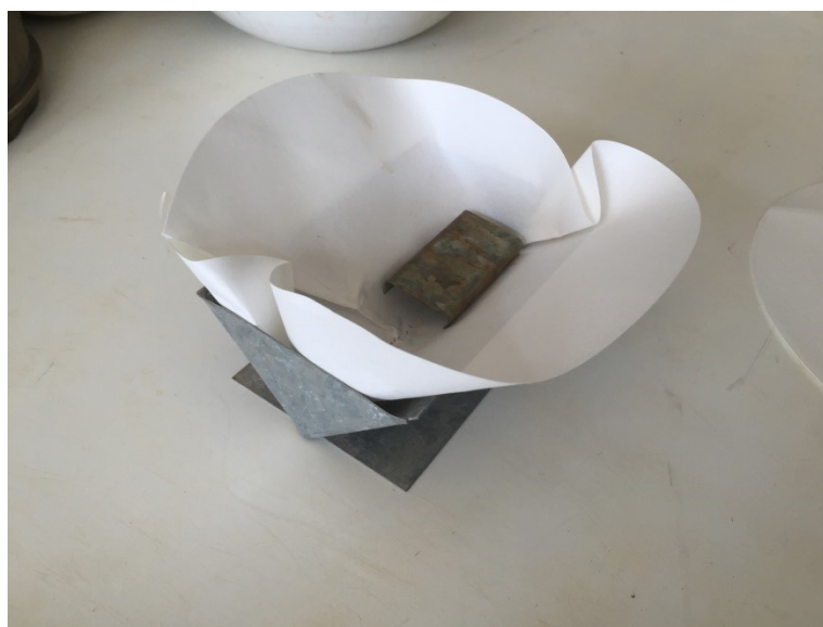
Figura 30 - Calha, filtro de papel e suporte metálico para ensaio de erodibilidade específica.
