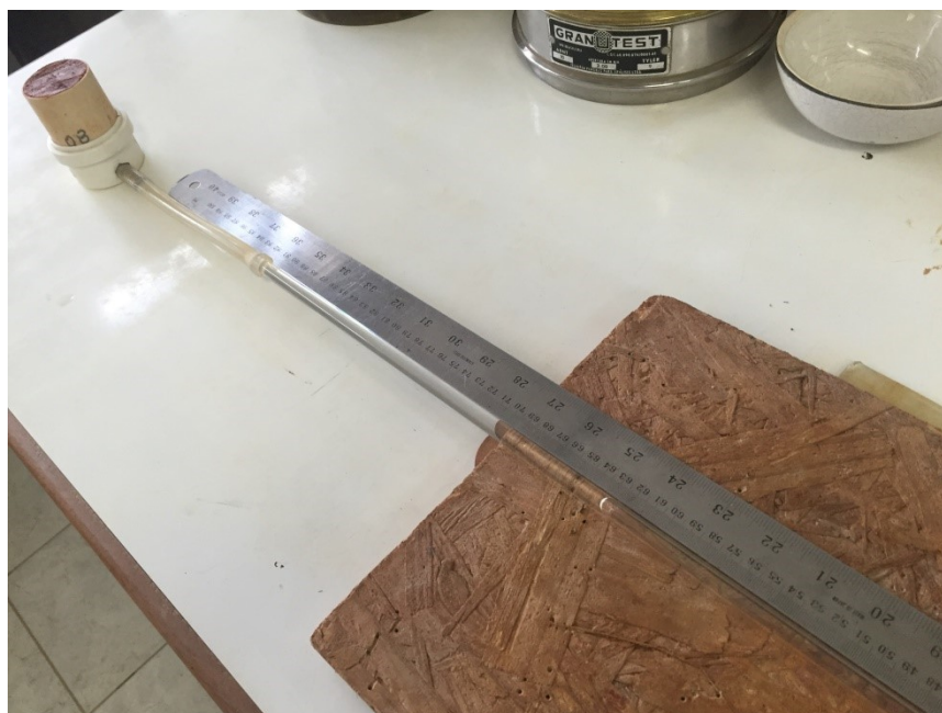
Figura 28 - Ensaio de infiltrabilidade em andamento.
