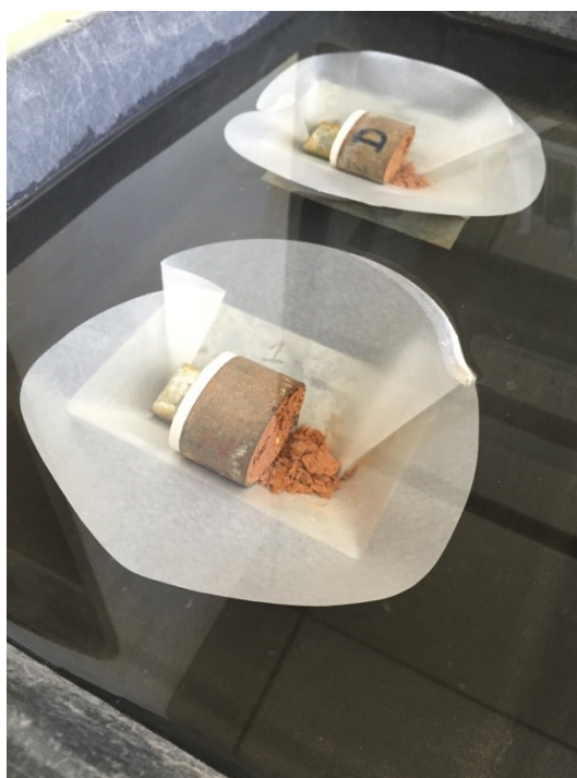
Figura 31 - Ensaio de perda de massa por imersão em andamento.
