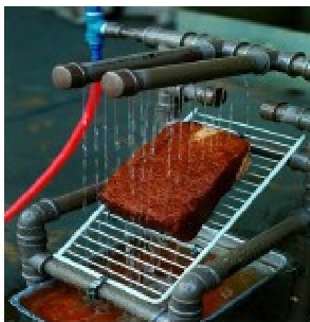
Figura 8 - Inderbitzen modificado (gotejamento).
