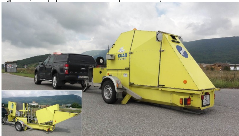
Figura 48 - Equipamento utilizado para a medição das deflexões
