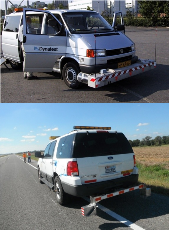
Figura 40 - Perfilômetro laser em dianteira e traseira de veículos
