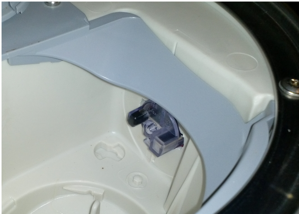
Figura 3.2: Foto do sensor de turbidez na máquina de lavar louça.
