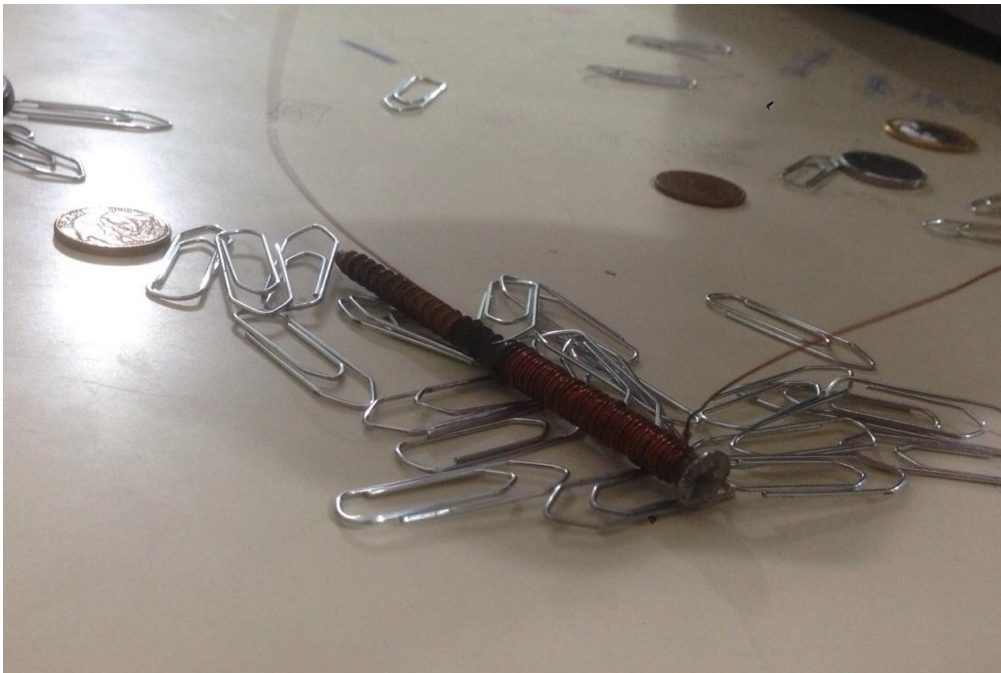
Figura 4.9: Eletroímã construídos em sala de aula pelos alunos
