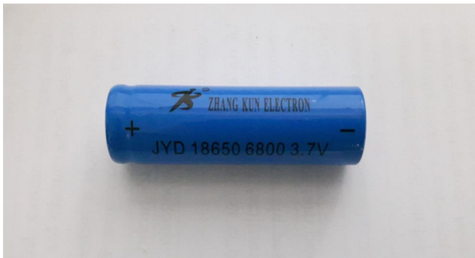
Figura 4.11: Pilha com alta amperagem usada nos experimentos em destaque
