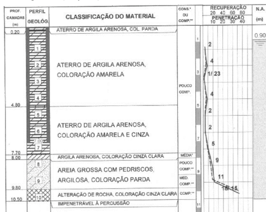
Figura 14 – Sondagens SPT em região de condição semelhante à unidade Csq.
