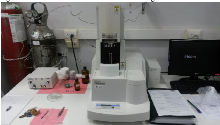
Figura 24 – Analisador térmico – ensaio de termogravimetria.
