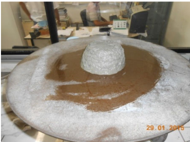
c) Moldagem da argamassa na mesa de abatimento.
