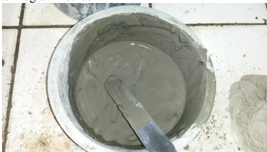
a) Preparação da pasta de cimento.
