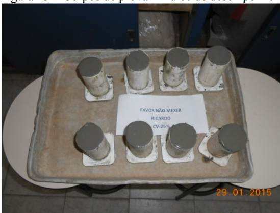
Figura 13 – Corpos de prova - Índice de desempenho com cimento Portland.
