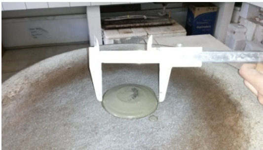
b) Espalhamento ensaio mini-slump .
