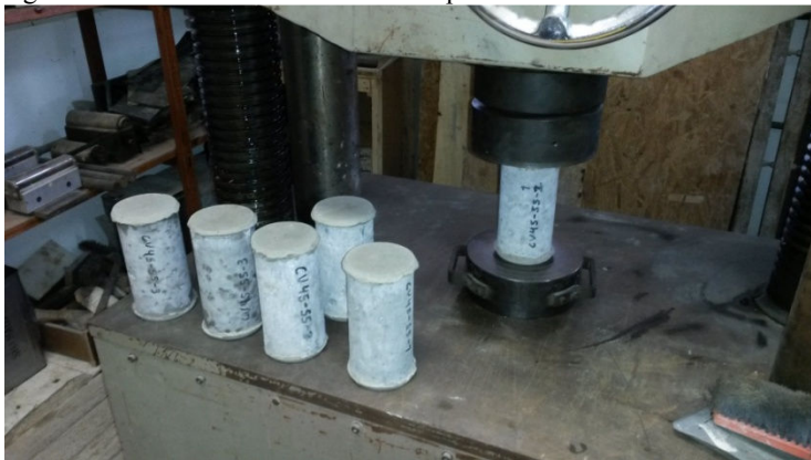
Figura 20 – Ensaio de resistência à compressão.
