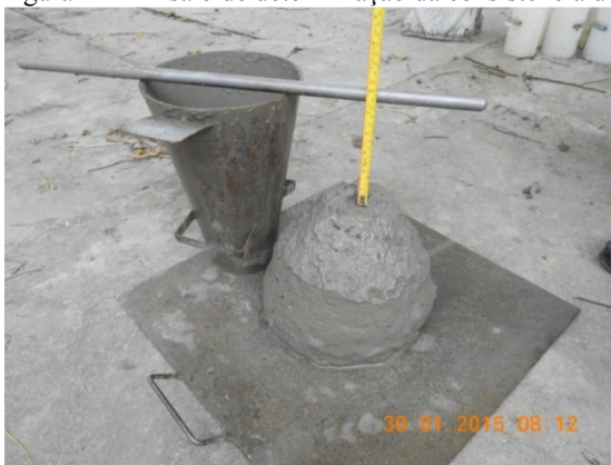
Figura 11 – Ensaio de determinação da consistência do concreto.
