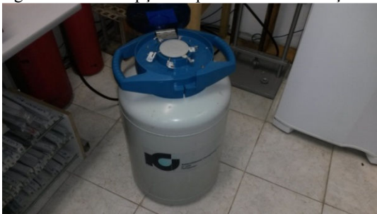
a) Tanque de nitrogênio líquido.
