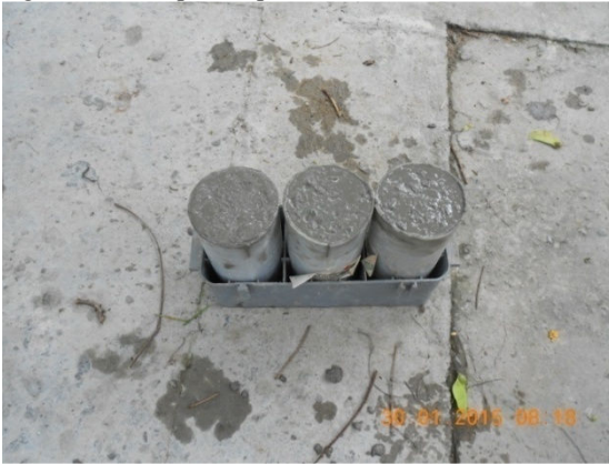
Figura 19 – Corpos de prova de concreto - ensaio de resistência à compressão.
