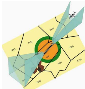
Figura 53 - Restrição do espaço aéreo nas proximidades de aeroportos. Fonte: Erba e Piumetto (2012)
