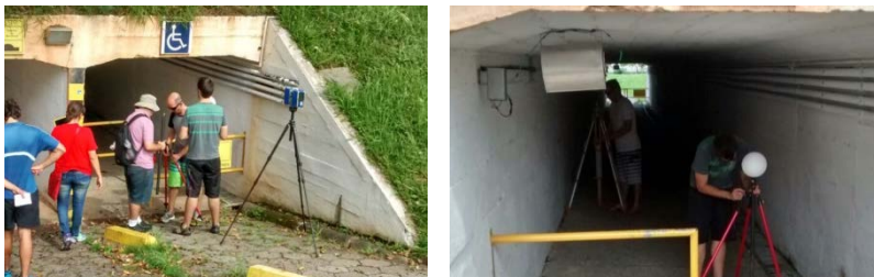
Figura 83 - Posicionamento do laser scanner na cena Tese2001 (esq.) e distribuição de alvos esféricos no interior do túnel (dir.).
