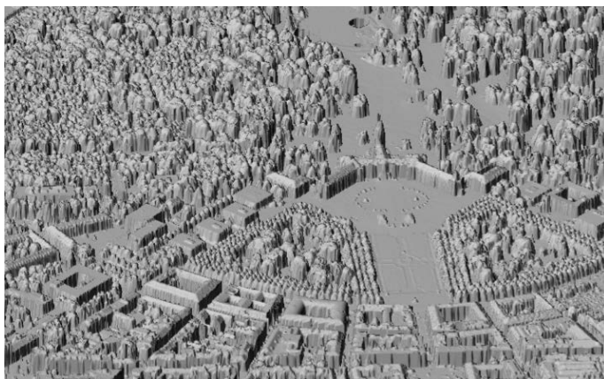
Figura 9 - Produto típico de varredura a laser, Modelo Digital de Elevação, cidade de Karlsruhe. Fonte: adaptado de Lohr (1999).
