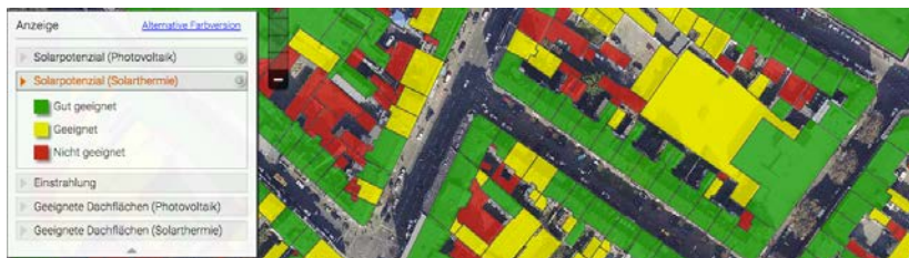
Figura 47 - Potencial térmico solar por edificação, Düsseldorf, Alemanha. Fonte: http://details.solare-stadt.de/duesseldorf/
