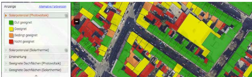
Figura 46 - Potencial fotovoltaico de geração de energia por edificação, Düsseldorf, Alemanha. Fonte: http://details.solare-stadt.de/duesseldorf/
