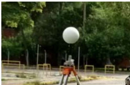
Figura 81 - Alvo esférico posicionado com base nivelante sobre tripé
