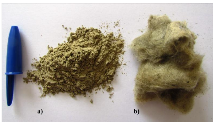
Figura 4 - Resíduo de lã de rocha: (a) após processo de moagem; (b) in natura .
