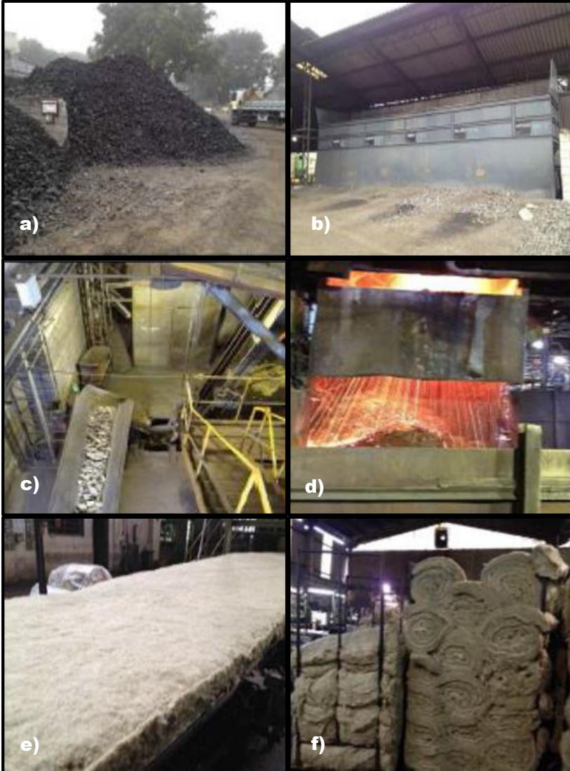
Figura 6 - Processo de produção de lã de rocha (Rockfibras, Guararema – SP). a) Matéria prima; b) Matéria prima sendo pesada; c) Matéria prima homogeneizada e sendo enviada ao forno; d) Fusão do material; e) Fibras pulverizadas e aglutinadas f) Formação das fibras.
