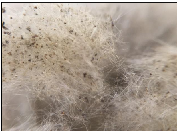
Figura 2 - Aparência do resíduo de lã de rocha, em forma de fibras.
