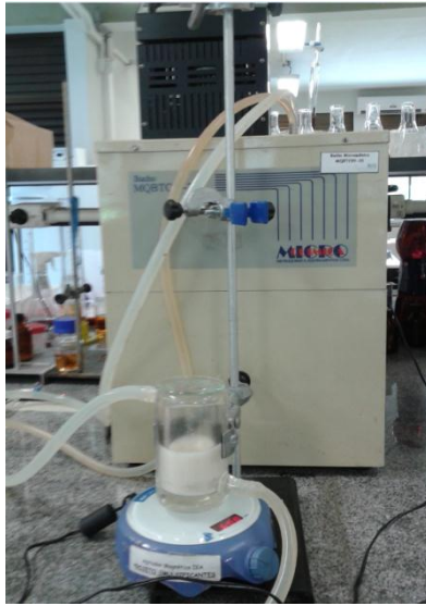
Figura 3.1 - Reator encamisado utilizado na etapa de polimerização das nanopartículas.
