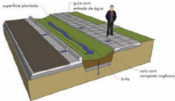
Figura 26: Esquema de uma biovaleta.
