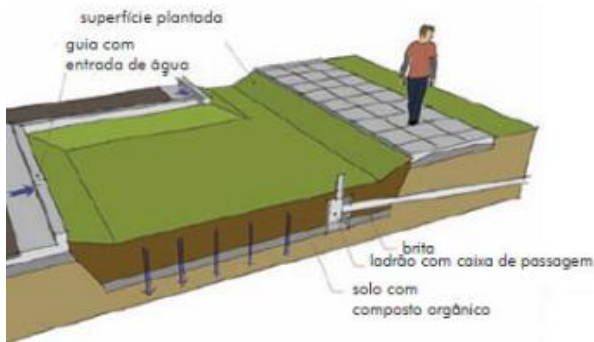
Figura 22: Esquema de um jardim de chuva.
