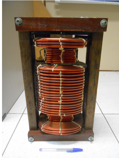
Figura C.1: Foto do Transformador A com três terminais utilizado nos experimentos.
