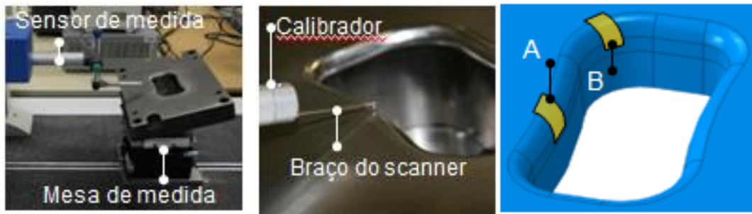
Figura 5. 10: Imagens demonstrando a medição da matriz no ponto A e comparação do desgaste dos pontos A e B da superfície da matriz
