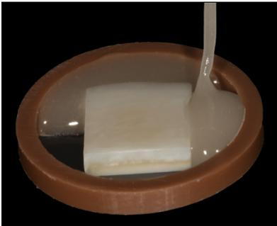
Figura 5. Espaço entre o espécime e o anel de PVC preenchido com resina acrílica.
