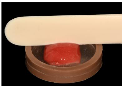
Figura 11. Remoção do excesso de gel e nivelamento com espátula de plástico.
