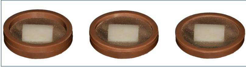
Figura 8. Matriz de PVC fixada aos espécimes com adesivo plástico para PVC.
