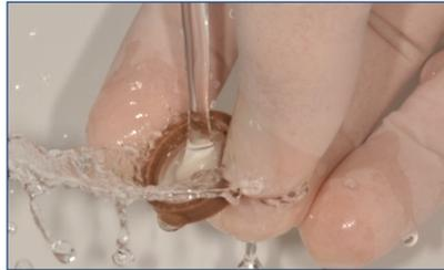
Figura 16. Enxague dos espécimes com água destilada por 60 segundos.
