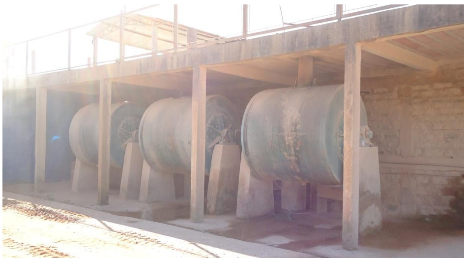
Figura 10 - Rolos de desbaste de pedras ágata
