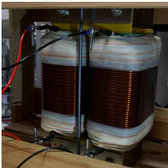
Figura 4.4 – Indutor auxiliar ( $L_a$ ) fabricado pela empresa Blutrafos.
