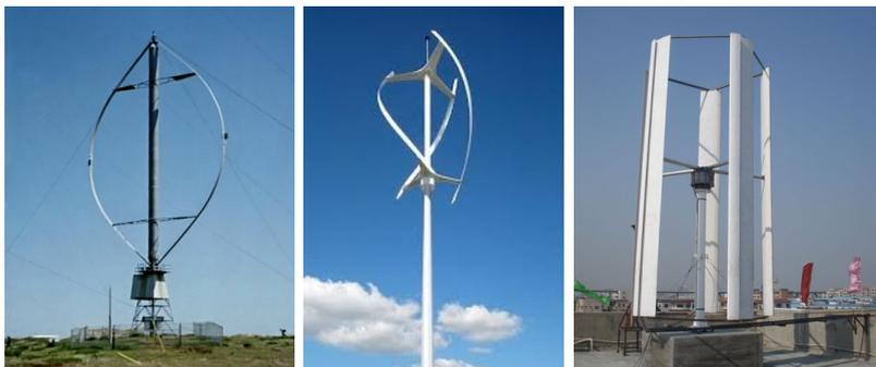
Figura 1.7 – Exemplos de estruturas de turbinas de eixo vertical. Fonte: <<http://cleantechnica.com>>. Acesso em: 29 abr. 2015.
