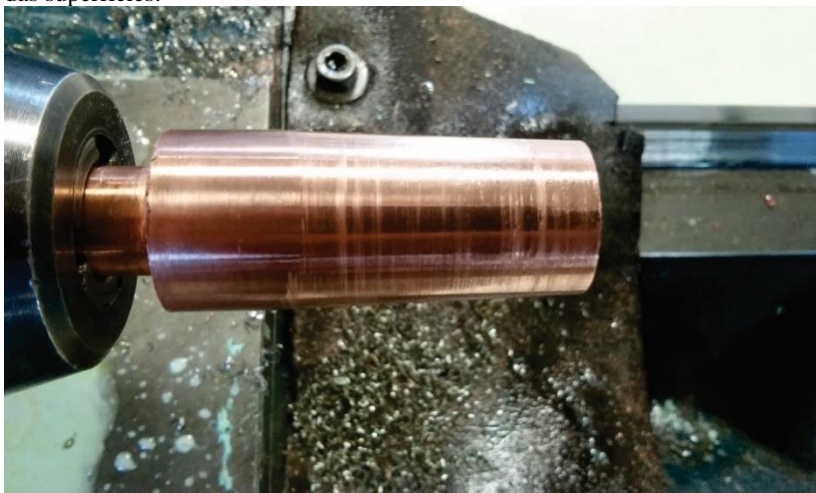
Figura 34 – Sulcos provocados pelo desprendimento de material durante desgaste das superfícies.
