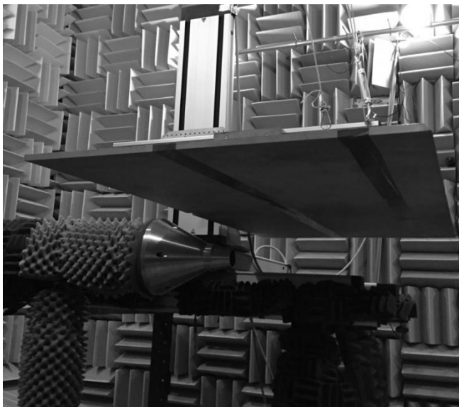
Figura 5.3 - Posicionamento da superfície em relação ao bocal liso (SMC000) durante os testes de caracterização do campo acústico (protegido).
