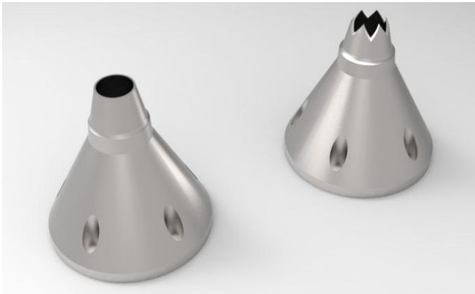
Figura 5.1 - Bocais ensaiados: SMC 000 (à esquerda) e SMC 006 (à direita).
