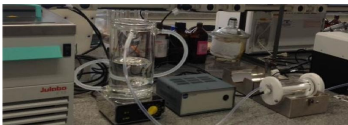
Figura 4 – Representação da configuração experimental constituída pelo fotorreator em escala laboratorial.
