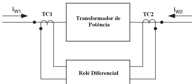
Figura 51 – Diagrama típico de conexão do relé diferencial.
