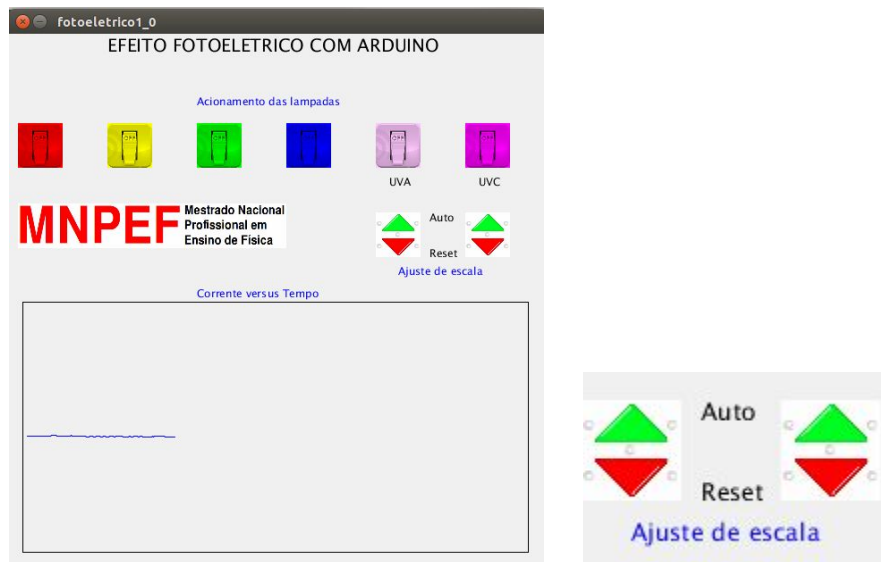
Fig. 5 - Aspecto da janela do programa e detalhe do botão de auto ajuste de escala
