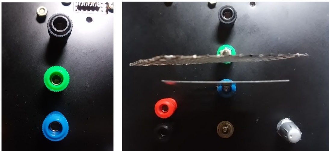
Fig. 2 - Posição da placa e grade no amperímetro.
