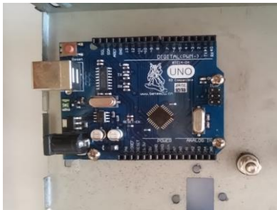
Figura 68 - Arduino fixado à caixa.
