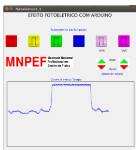
Figura 100 - Comportamento da curva no mesmo experimento, com o ajuste automático, no momento em que o fósforo é inserido e depois retirado.
