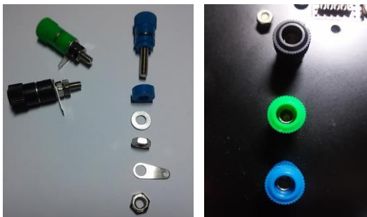
Figura 67 - Esquerda: conectores para pinos banana. Direita: Conectores montados na caixa.
