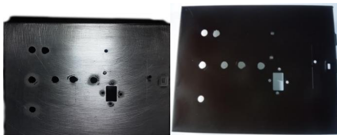
Figura 64 - Preparação da caixa de montagem.
