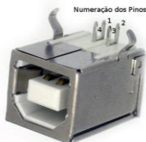
Figura 32 - Número dos pinos do conector USB.
