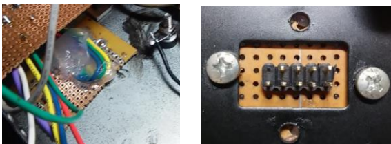
Figura 70 - Soquetes USB para as lâmpadas em uma placa padrão já na caixa da montagem.
