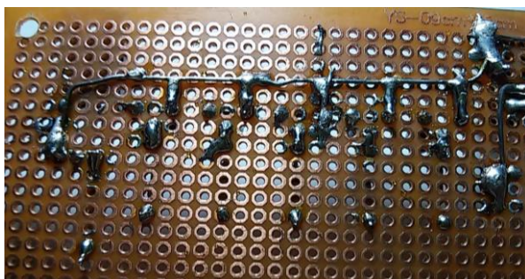
Figura 58 - Controle das lâmpadas visto do lado das soldas.
