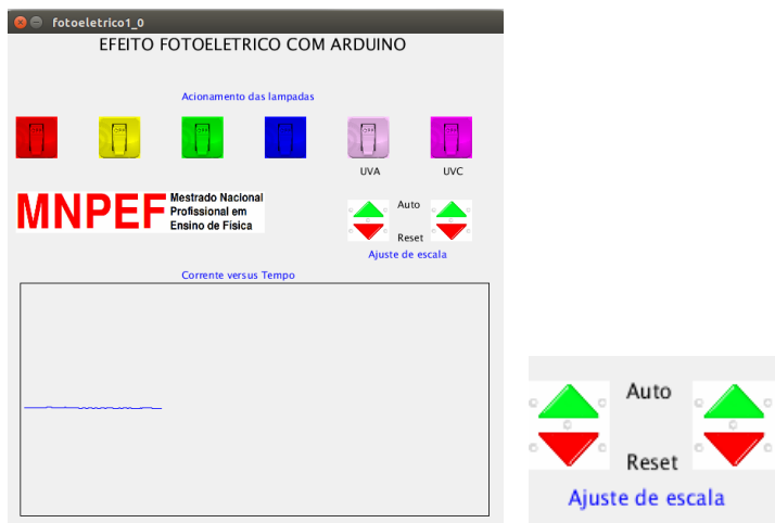
Fig. 5 - Aspecto da janela do programa e detalhe do botão de auto ajuste de escala
