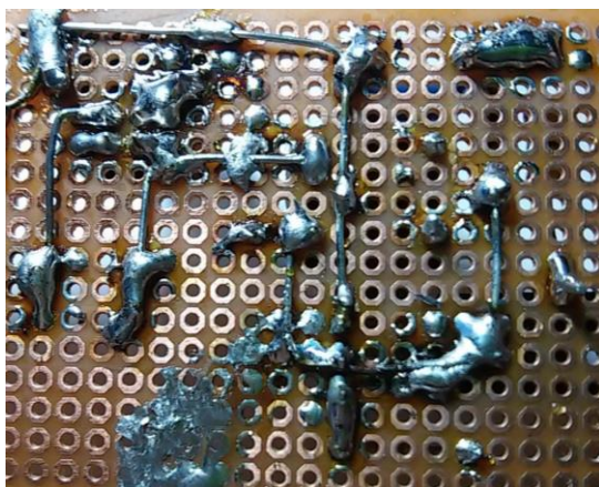
Figura 54 - Montagem da fonte AT vista do lado das soldas.
