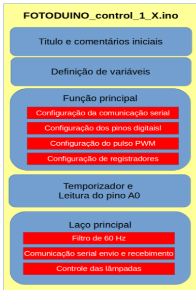
Figura 87 - Diagrama de blocos do código do Arduino.
