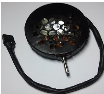
Figura 38 - Caixa metálica das lâmpadas
