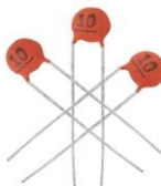
Figura 25 - Capacitores cerâmicos de 10 pF e 50 V usados no projeto.
