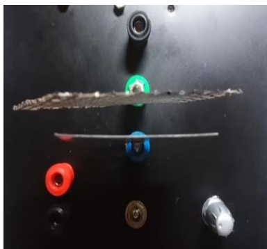
Fig. 2 - Posição da placa e grade no amperímetro.
