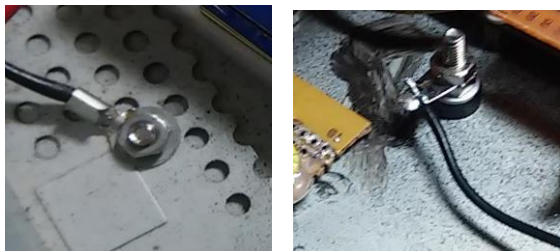
Figura 71 - Detalhe da ligação ao aterramento na caixa metálica.
