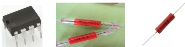
Figura 4 - Amplificador CA3420 e resistor 10 G \Omega .
