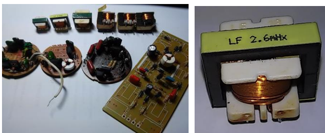
Figura 27 - Indutores retirados de sucata. A direita, indutor de 2,6 mH.
