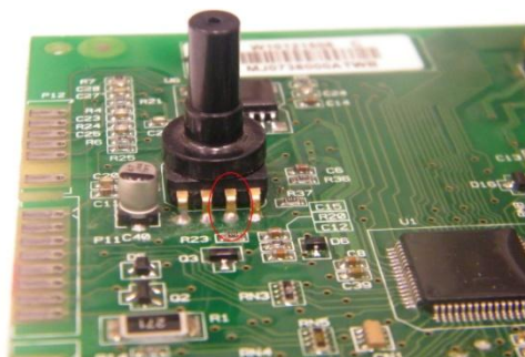
Figura 28 - Sensor de pressão na placa de controle
