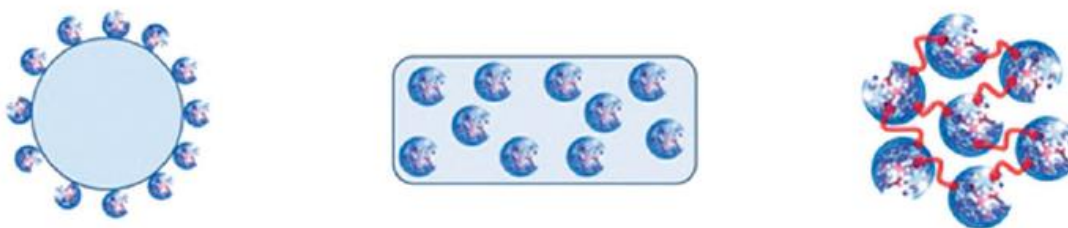
Figura 2. Diferentes métodos de imobilização de enzimas: adsorção (à esquerda), aprisionamento (ao centro) e ligações cruzadas (à direita). As enzimas estão representadas pelas esferas. [9]
