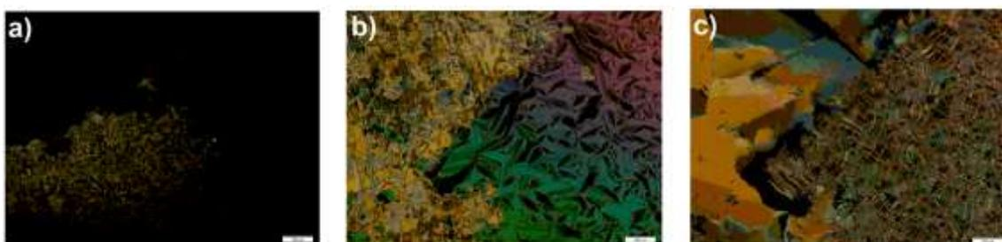
**Figura 14.** Caracterização das mesofases do composto CL-134S por MOLP. a) Transição do líquido isotópico para a fase nemática em 285 °C; b) Fase SmC com alinhamentos paralelos e perpendiculares das moléculas em 190 °C; c) Estado cristalino em 85 °C.
