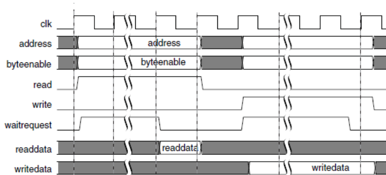
Figura 15: Exemplo de transferência de dados na interface Avalon-MM
