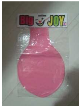
Figura 9 – Balão utilizado para obtenção da resposta impulsiva das salas
