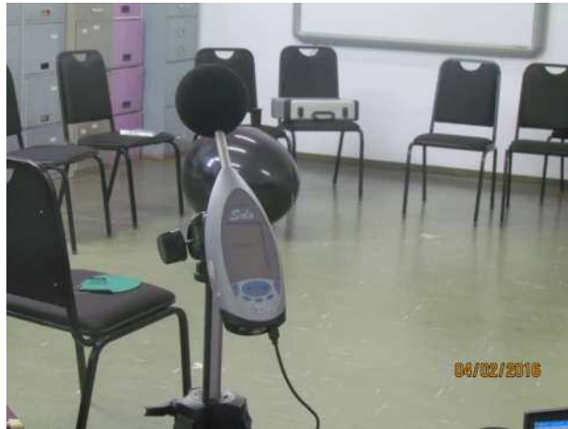
Figura 11. Equipamento solo instalado para medição dos parâmetros acústicos
