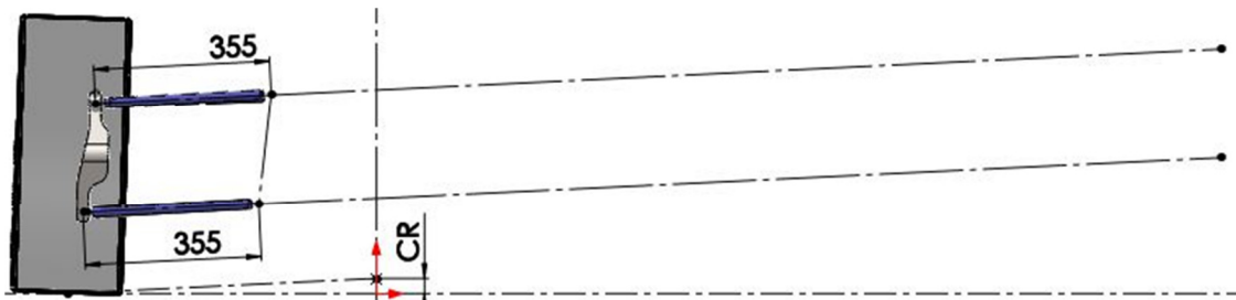
Figura 7 – Suspensão de braços inclinados e paralelos (Caso 2)
