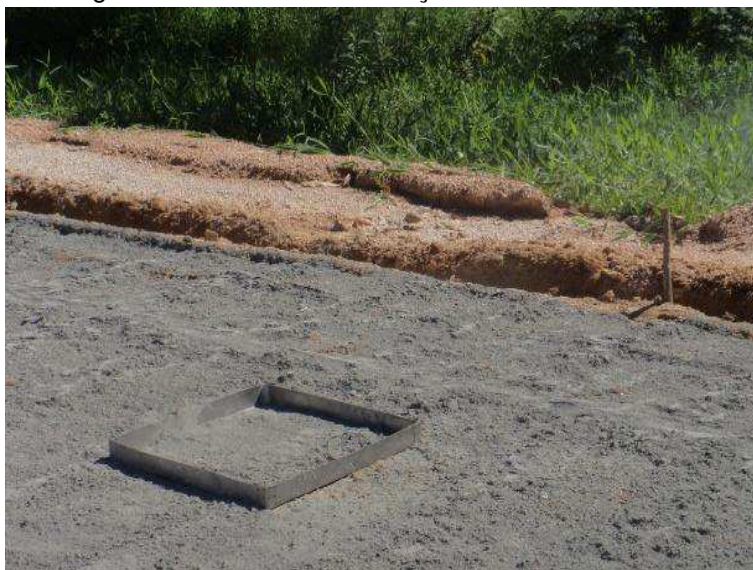
Figura 23 - Ensaio de verificação da taxa de cimento
