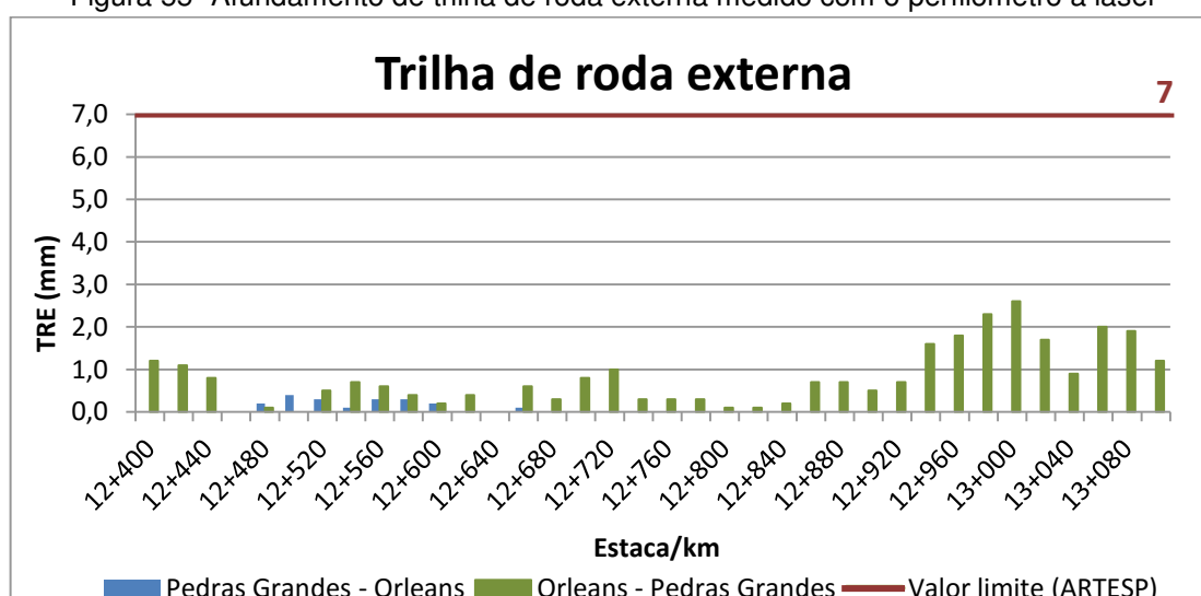
Figura 55- Afundamento de trilha de roda externa medido com o perfilômetro a laser
