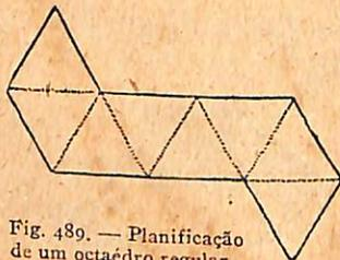
Fig. 489. — Planificação de um octaédro regular.
