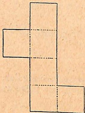
Fig. 484. — Planificação de um cubo.
