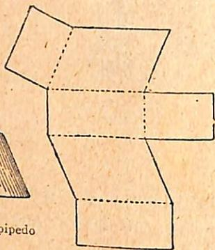
Fig. 523. — Planificação do parallelepipedo obliquo.
