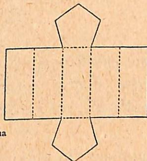
Fig. 521. — Planificação do prisma pentagonal.
