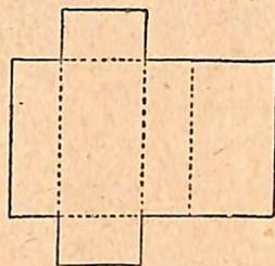
Fig. 519. — Planificação do prisma quadrangular.
