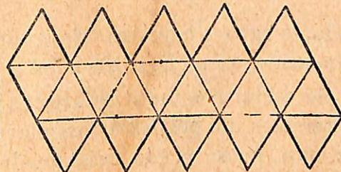
Fig. 493. — Planificação de um icosaédro regular.
